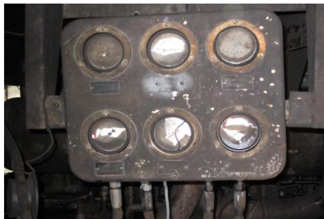
Fig.4. Panoul de supraveghere al motorului diesel afectat termic
