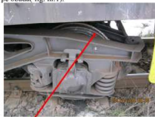
Fig.1 Roata nr. 5 cu bandajul deplasat
