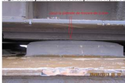
Fig.5 Jocul la piatra de frecare corespunzător roților 1-3
