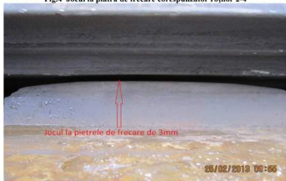
Fig.4 Jocul la piatra de frecare corespunzător roților 2-4
